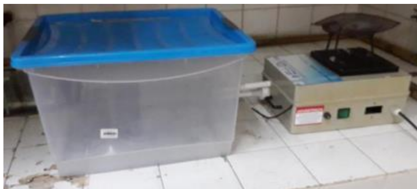
Figura 17 Cámara de ozonización
